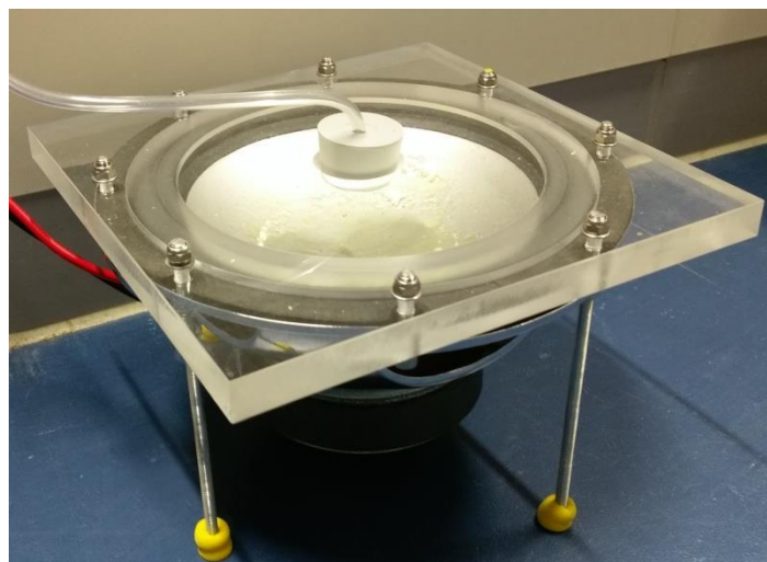
Abbildung 8: Lautsprecher zum Erzeugen des akustischen Stimulus; die Plexiglasplatte wurde druckdicht an den Lautsprecher geschraubt; das Loch in der Mitte der Platte ist mit einem Gummistöpsel abgedichtet; mittig aus dem Stöpsel geht der Schlauch hervor, durch den der Schall zum Probanden geleitet wird (Foto von V. Lücke)
